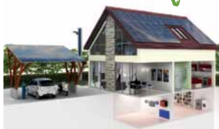
Bei der Photovoltaiktechnologie wird die Sonnenenergie aktiv genutzt um Strom zu produzieren. Dieser gelangt in den Stromspeicher, wo er bei Bedarf für Heizung, Warmwasserbereitung oder E-Ladestationen zur Verfügung steht.
