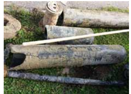
Nachdem das Leck gefunden wurde, musste die geplatzte Leitung ausgetauscht werden
